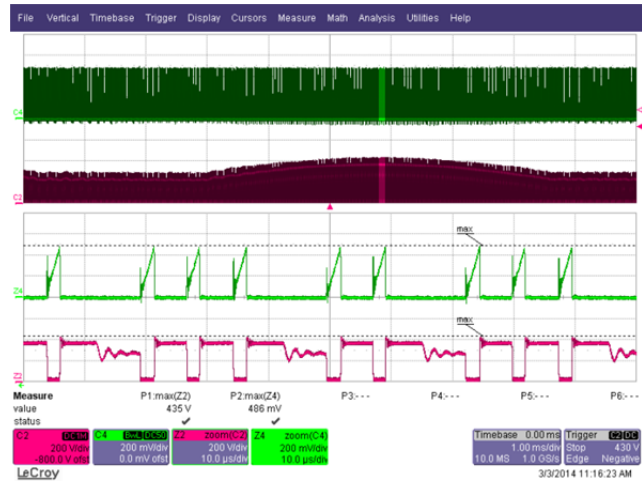
Figure 31 – 190 VAC, Full Load. Upper: I_{DRAIN} , 0.2 A / div. Lower: V_{DRAIN} , 200 V / div. Time Scale: 1 ms / div. Zoom Time Scale: 100 \mu s / div.
